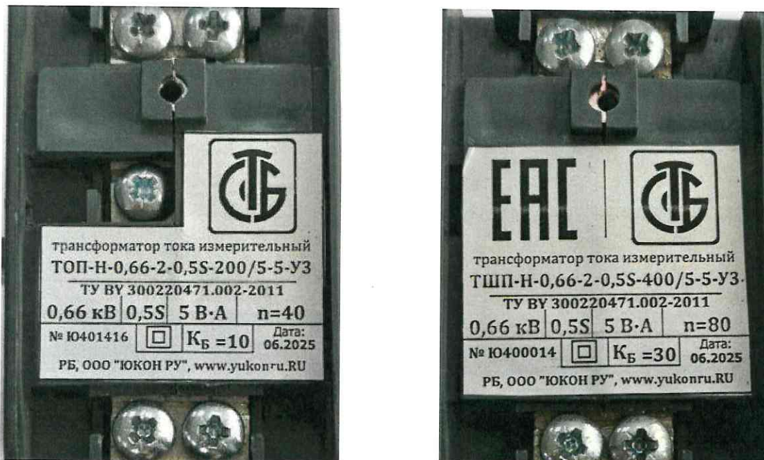
Рисунок 1.2 – Фотография маркировки трансформаторов тока измерительных ТОП-Н-0,66 и ТШП-Н-0,66 (изображение носит иллюстративный характер)
